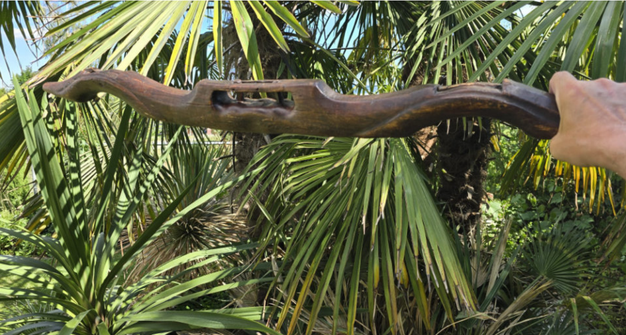
Das Joch verteilt die Last auf zwei Schultern. Foto: B. Hänggi
